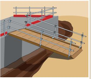
J'installe une passerelle d'accès avec plancher antidérapant et garde-corps.
