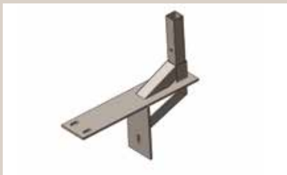
Fig. 4 - Console de départ à cheville sur dalle béton
