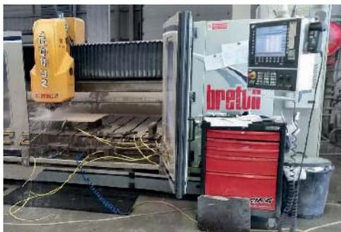
Centre d'usinage (découpe jet d'eau + abrasifs sur lit d'eau)
